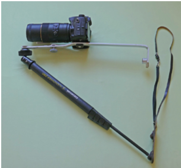
Abb. 4: Halsgurt mit Brustschild zur Verwendung der Schulterstütze mit Einbeinstativ als Bruststativ.
